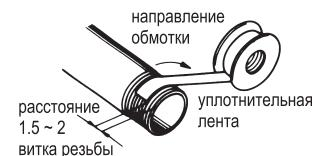
Для получения герметичного соединения необходимо уплотнить наружную резьбу трубопровода тefлоновой лентой, отступив от конца резьбы 1,5-2 витка. Направление намотки тefлоновой ленты должно быть противоположным направлению закручивания подсоединяемого трубопровода.
