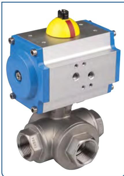
3/2-ходовой полнопроходной шаровой кран из нержавеющей стали пред-назначен для смешивания и распределения нейтральных и агрессивных жидкостей. Так-же может использоваться для пара. В зависимости от конструкции шара кран может использоваться для различных функций. Нержавеющая сталь и уплотнение PTFE гарантирует длительную эксплуатацию крана при самых сложных условиях работы.
