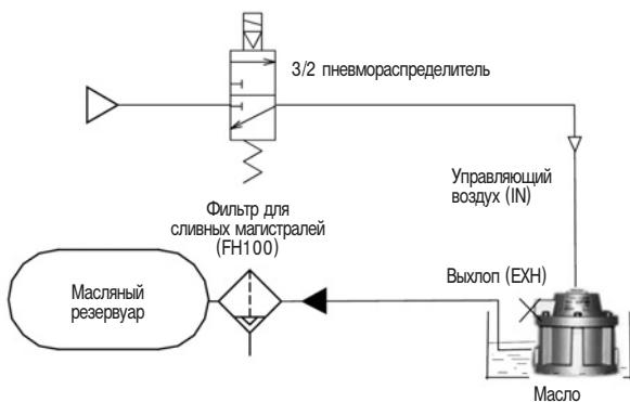
При использовании пневмораспределителя 3/2 выхлопной порт можно заглушить и насос применять как насос погружного типа.
