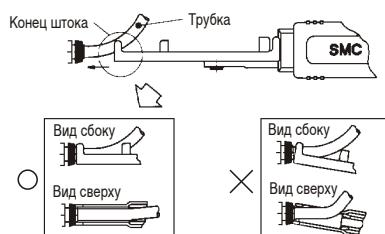
2. Осторожно вставьте конец трубы в паз на конце штока инструмента, удерживая прижимное устройство на ручке. (Внимание: зажим должен быть достаточно жестким во избежание случайного выпадения трубы).
