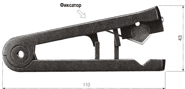
Внимание: никогда не используйте для разрезания проводов, содержащих металл, например, электрических кабелей
